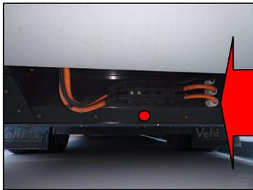
Prise de puissance branchée/débranchée. Un simple clip permet de la débrancher afin d'isoler au plus près le bac à batteries (qui demeure en 600v !) Un témoin lumineux **allumé/éteint** indique que le véhicule est **en/hors « haute tension »**. Il existe 2 prises de puissance : une à l'arrière sous le compartiment batteries et une sous le capot moteur.
